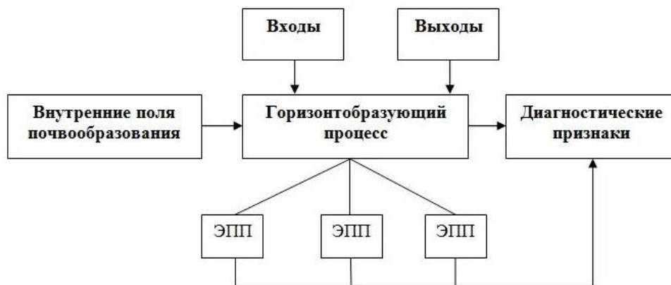
Рис. 2. Схема анализа горизонтобразующего процесса (ЭПП – элементарный почвенный процесс)
