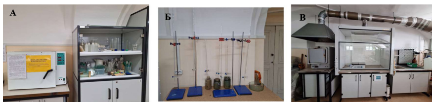
Приборы и оборудование: шкаф для сжигания гумуса и шкаф с посудой (А), набор бюреток (Б), муфельная печь, вытяжной шкаф и раковина (В)
